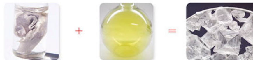
Fig. 1.25 El compuesto cloruro de sodio se obtiene de la unión de los átomos de los elementos sodio y cloro. Las propiedades de los elementos que forman el compuesto son totalmente distintas de éste.
