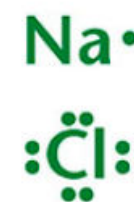
Fig. 2.20 Representación de la distribución de electrones de valencia, de acuerdo con el modelo de Lewis, para el sodio (Na) y el cloro (Cl).
