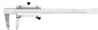
Fig. 1.14 El vernier tiene dos escalas, cerciórate de tomar la medida correcta usando ambas. Si tienes dudas, pregunta a tu profesor.
