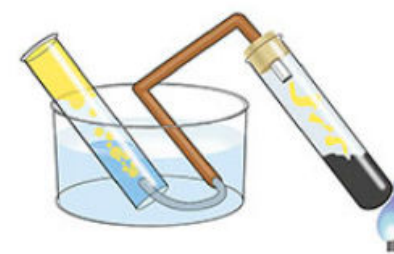
Fig. 1.17 Técnica de desplazamiento de agua para captar un gas y medir su volumen.
